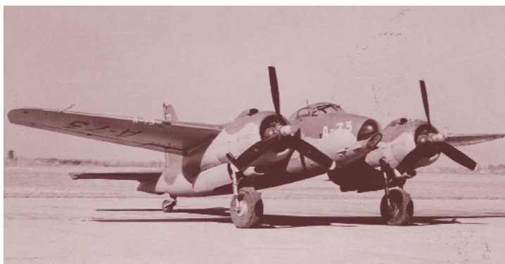
Bombardero Calquín, de velocidad similar al anterior. Se hicieron 100 en la Fábrica Militar de Aviones de Córdoba. Fueron construidos con maderas nacionales compensadas.
