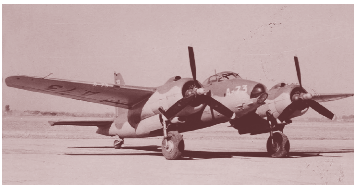
Bombardero Calquín, de velocidad similar al anterior. Se hicieron 100 en la Fábrica Militar de Aviones de Córdoba. Fueron contruidos con maderas nacionales compensadas.
