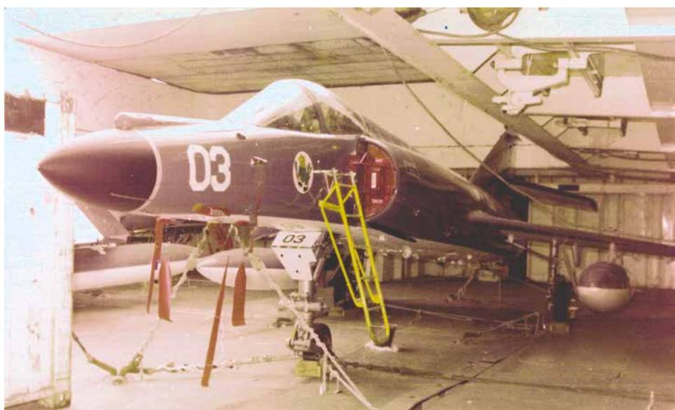
La carga de las aeronaves, el material más sensible, se hizo sin novedad. Se embarcaron con la punta de las alas plegadas y se estibaban y trincaban con sumo cuidado, separadas del resto de la carga. La zarpada se demoró por una inspección de las autoridades portuarias. Finalmente y sin novedad se zarpó rumbo a Puerto Belgrano.
