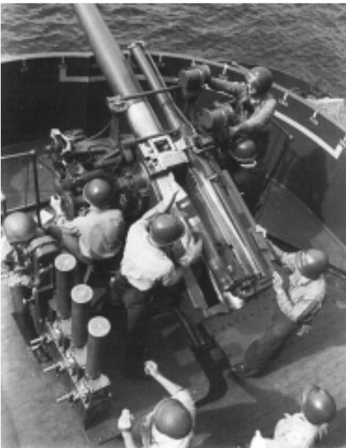
Cañón de doble propósito de 127/25 mm de la batería secundaria del acorazado de los EE.UU. *New Mexico*.
