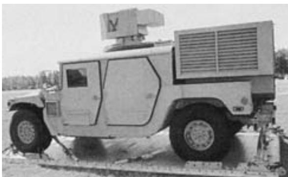
tor, ubicado sobre la cabina, dirige las radiaciones sobre la ruta a transitar a una distancia de 250 metros produciendo el calentamiento del suelo y, consecuentemente, la explosión de las minas terrestres. La imagen del vehículo permite apreciar lo reducido de la pequeña cúpula de irradiación y la sencillez de su operación.
